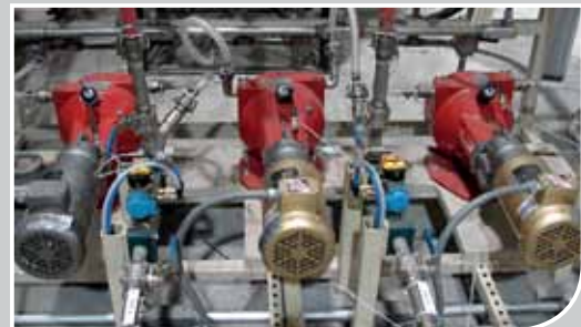
Déjà 36 pompes LPP-D viennent renforcer la précision du dosage chez James Hardie.
